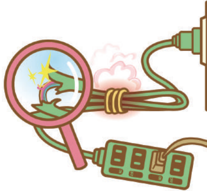
電線 不 綑綁折損
