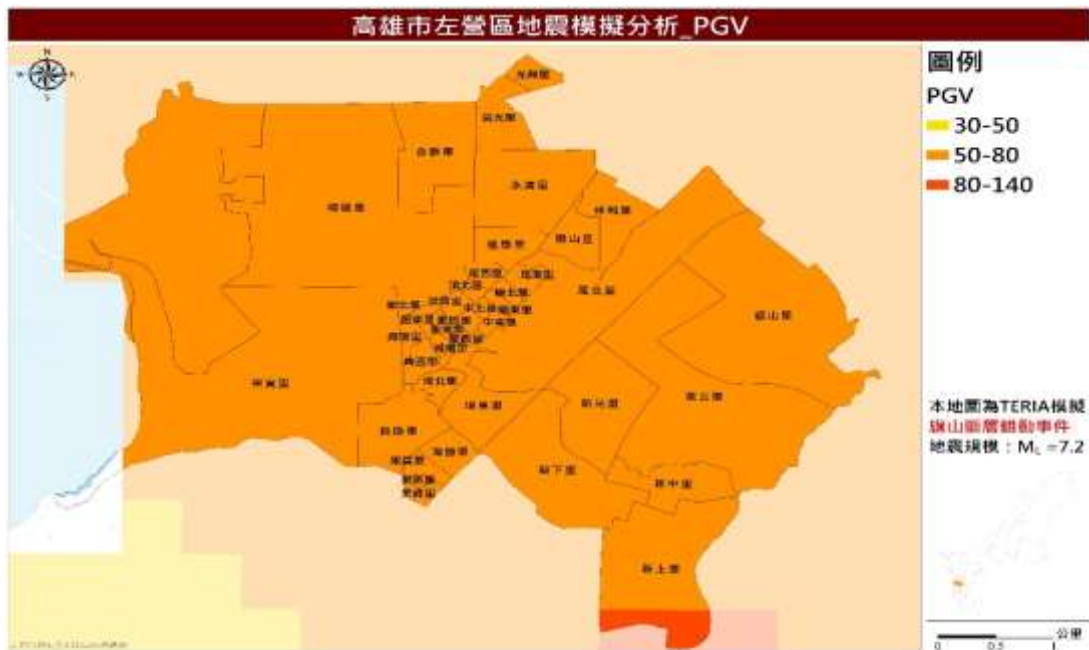
圖 15 旗山斷層錯動事件最大地表速度值（PGV）分布圖
