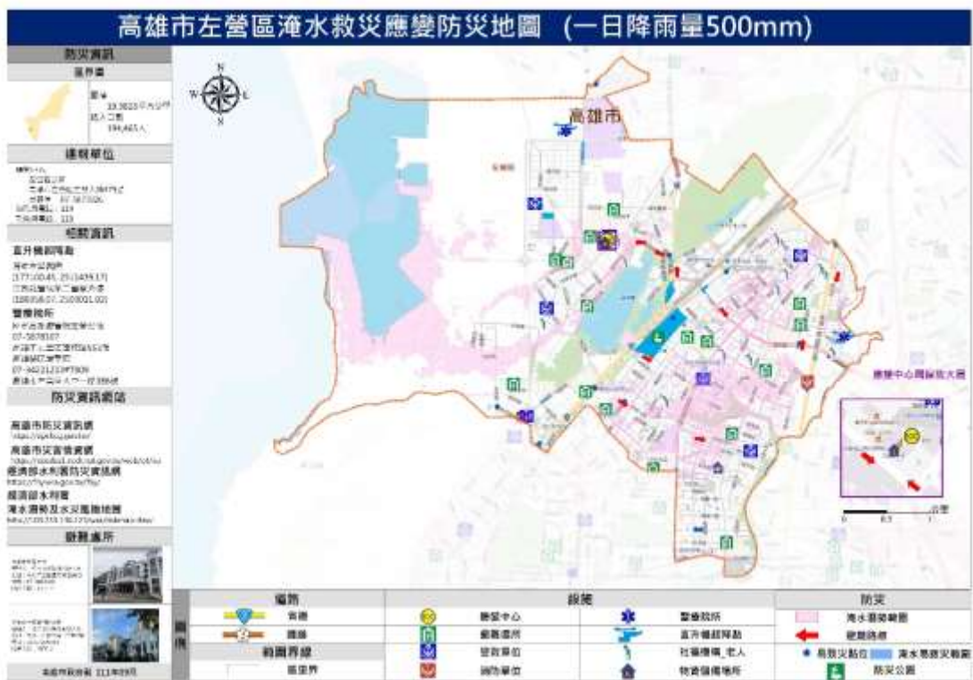
圖 8 左營區淹水災害潛勢圖 (模擬 24 小時累積降雨量 500mm)
