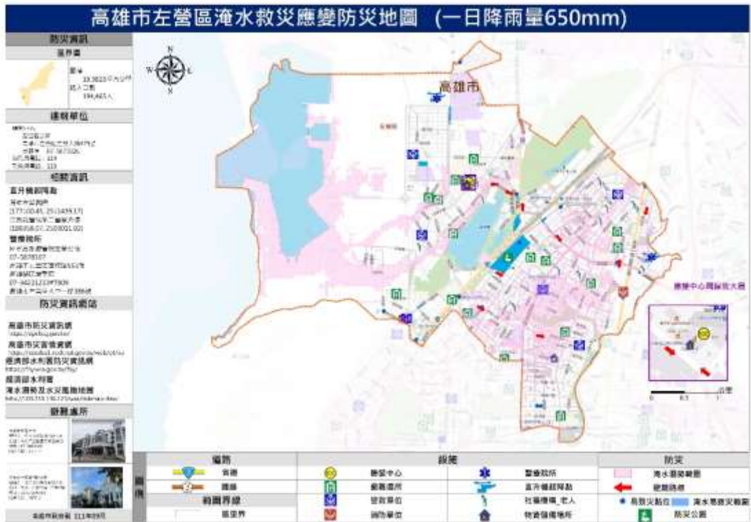
圖 7 左營區淹水災害潛勢圖 (模擬 24 小時累積降雨量 650mm)
