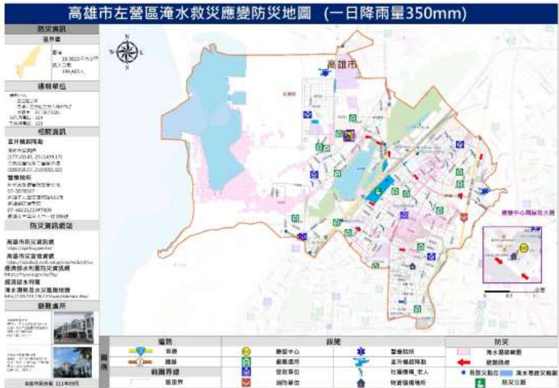
圖 9 左營區淹水災害潛勢圖 (模擬 24 小時累積降雨量 350mm)
