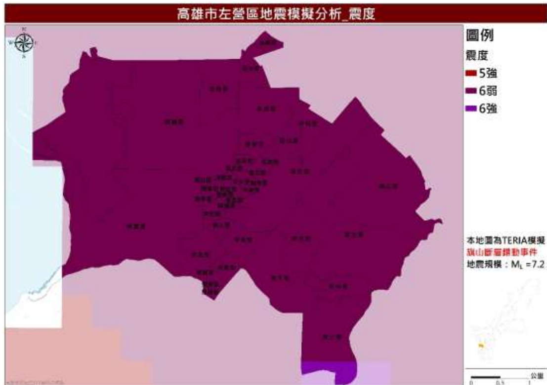
圖 16 旗山斷層錯動事件震度分布圖
