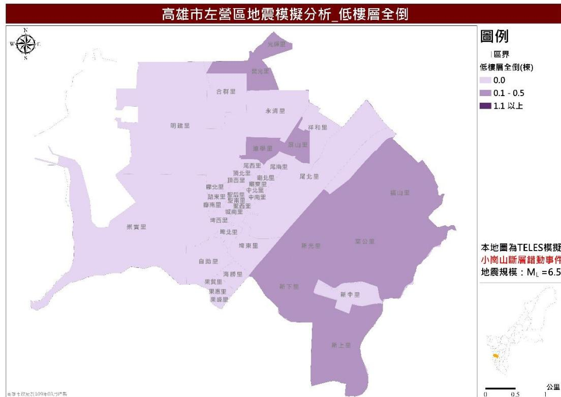
圖 19 小崙山斷層錯動事件低樓層全倒棟數推估圖
