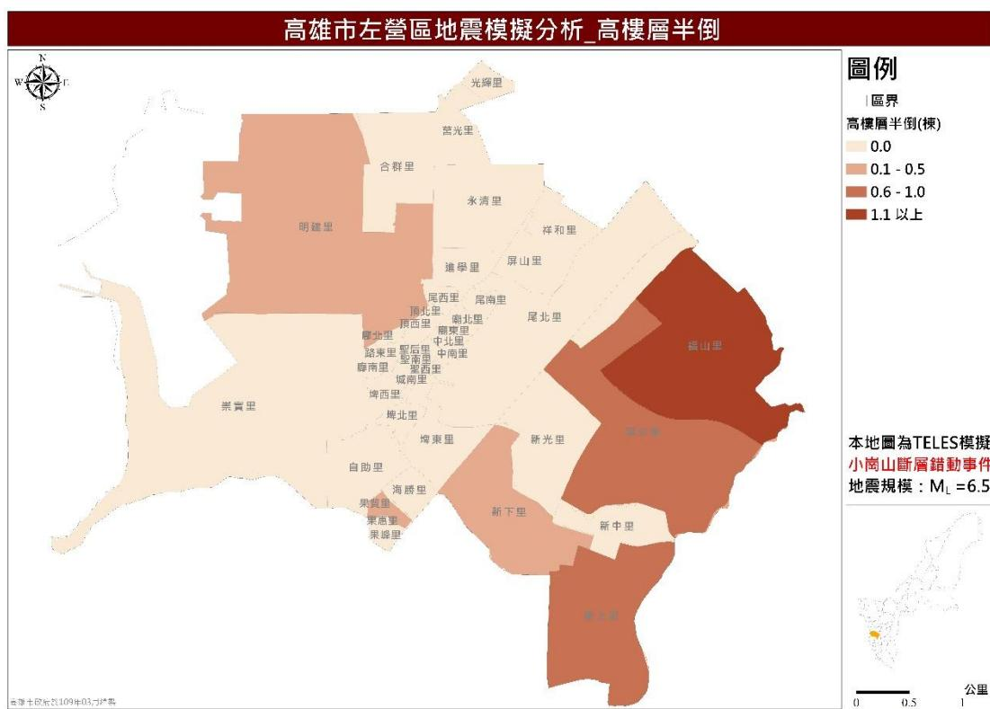
圖 24 小崙山斷層錯動事件高樓層半倒棟數推估圖
