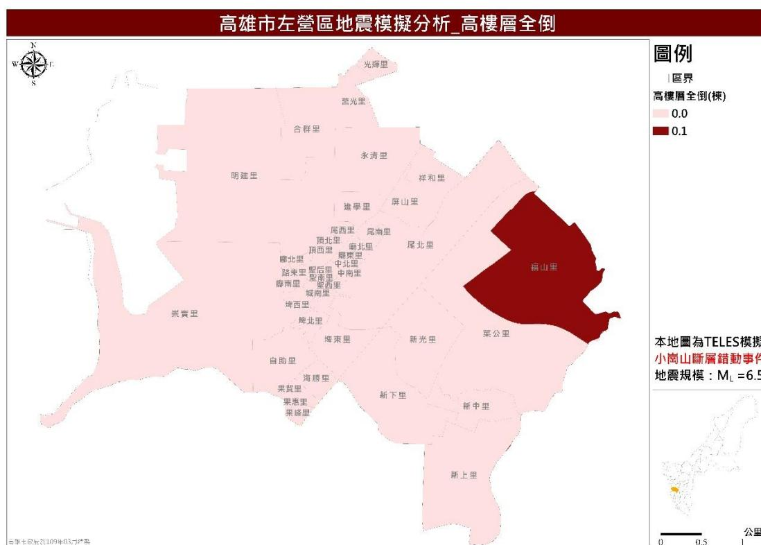
圖 21 小崙山斷層錯動事件高樓層全倒棟數推估圖
