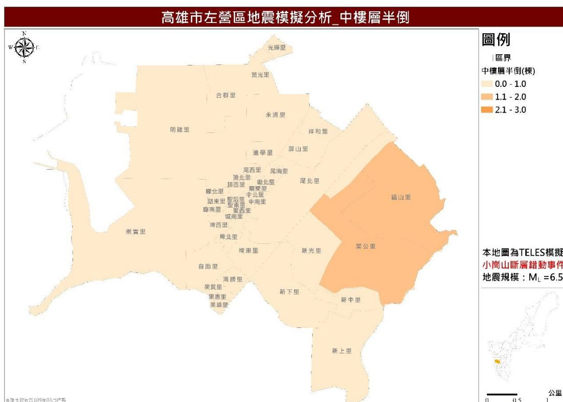
圖 23 小崙山斷層錯動事件中樓層半倒棟數推估圖
