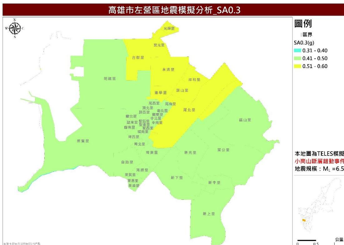
圖 16 小崗山斷層錯動事件短周期譜加速度 (SA0.3) 分布圖
