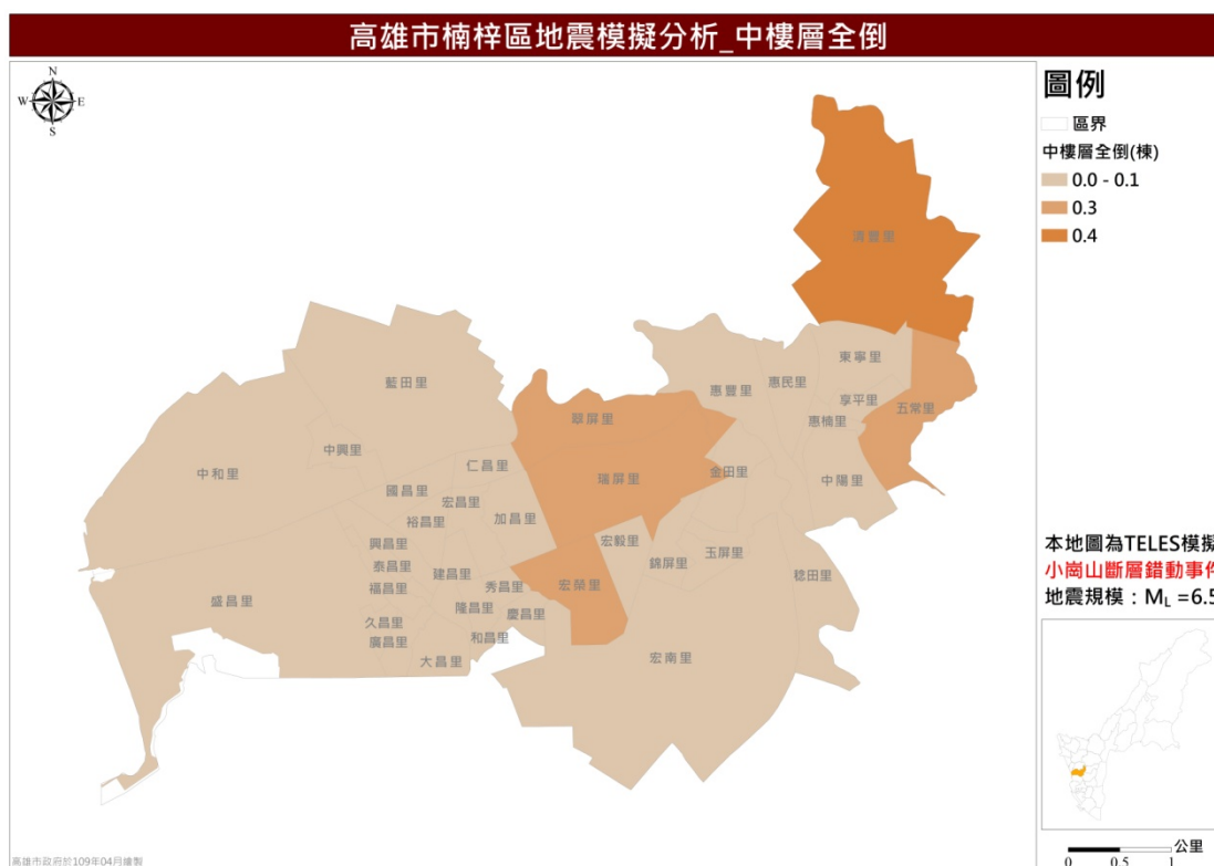
圖 19 小崗山斷層錯動事件中樓層全倒棟數推估圖
