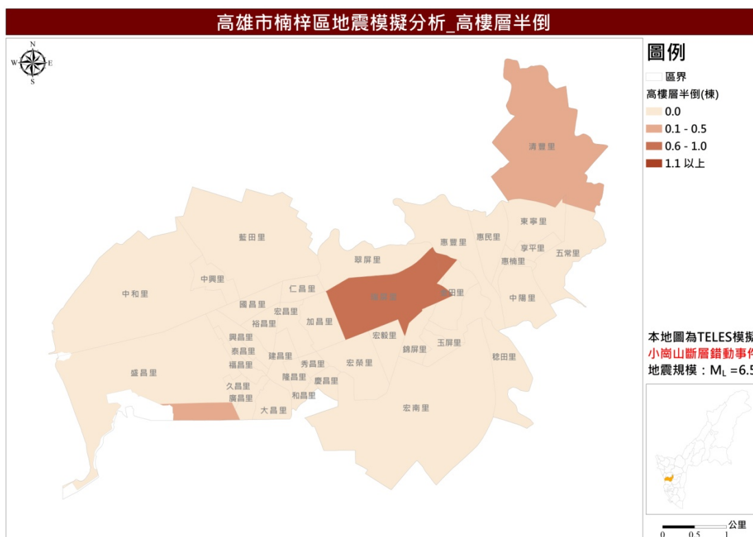
圖 23 小崗山斷層錯動事件高樓層半倒棟數推估圖
