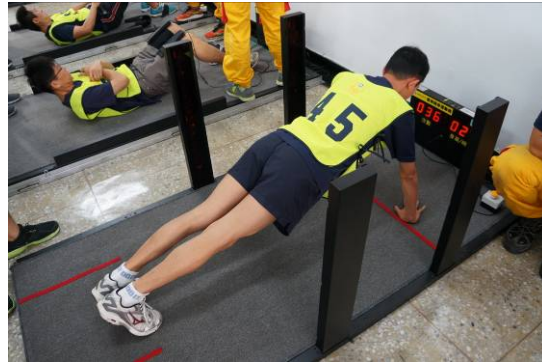
圖 9. 受測者軀體下壓深度達標準後，再推撐回升時，其肩部及臀部須回復原來紅外線感測器感應初始高度位置，始完成動作並計數 1 次
