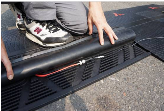
圖 1. 組合式感應地墊連結傳輸線回傳感應資訊至類比數位讀取器
