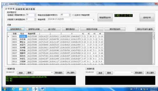
圖 5. 成績系統軟體程式可紀錄跑者每圈經過感測點時間，並換算每圈所耗時間等動態資訊。
