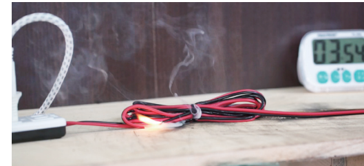
圖 5. 電線不當束綁起火之情形
