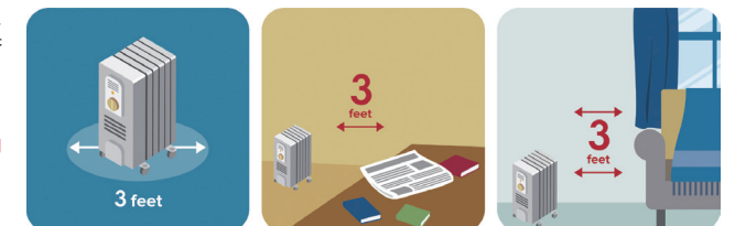
電暖器一公尺內避免放置可燃物品（資料來源：美國聯邦消防署）
