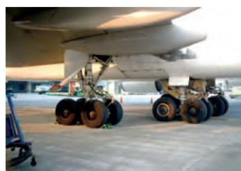
注意：滅火時應由前方或後方接近機輪以避免機輪爆炸受傷。
