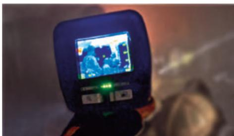
熱顯像儀利用偵測紅外線輻射熱之顯像以表示溫度高低
