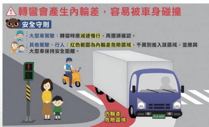
圖 2. 大型車轉彎內輪差示意圖 資料來源：交通部交通安全入口網
