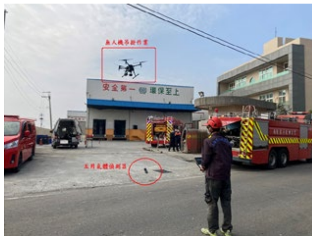
吊掛五用偵測器進入災區檢測模擬演練
