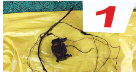
照片 5. 水族箱加溫器燃燒後之情形(圖片來源內政部消防署)
