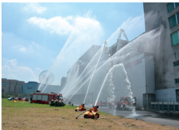
照片 4. 圖中央為履帶式遙控砲塔車射水攻擊
