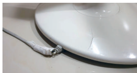
照片 3. 電風扇電源線接點損傷
