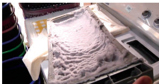
照片 8 烘乾機濾網需定期清洗，減少灰塵、棉絮沾積
