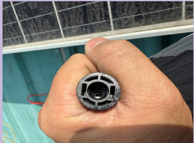
▲ 圖 5、直流連接器內部導體損壞（資料來源：作者拍攝）
