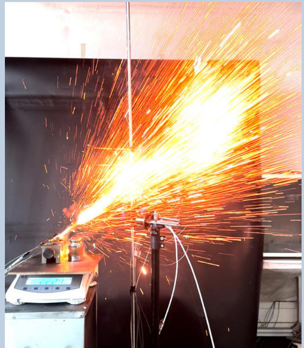
▲ 圖 3、鋰電池燃燒的噴射狀火焰 (資料來源： https://www.nist.gov )
