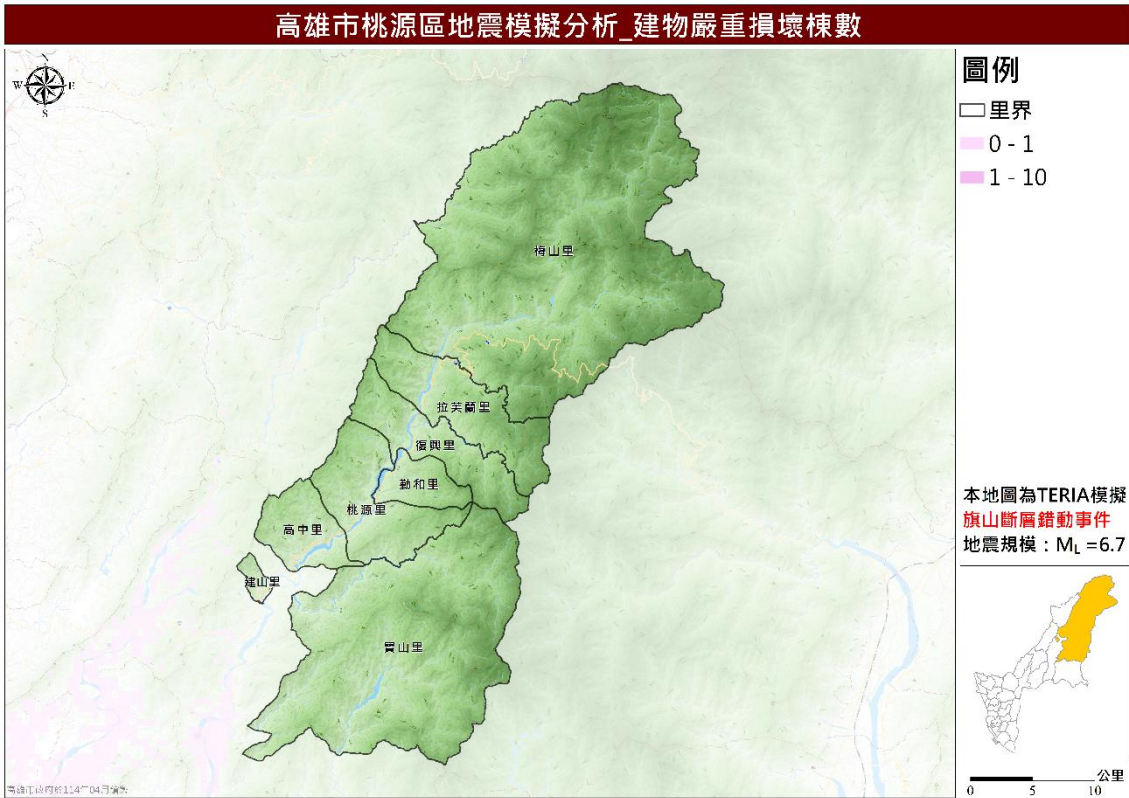
圖 11 旗山斷層錯動事件建物嚴重損壞棟數推估圖
