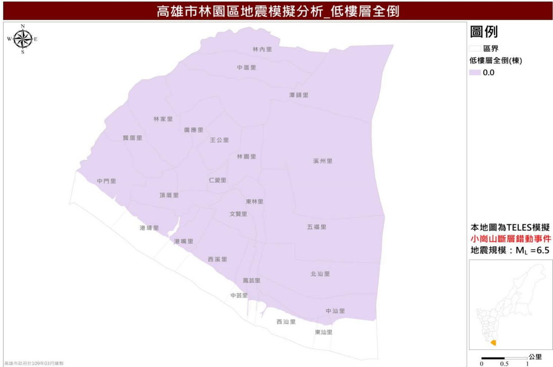
圖 16 小崗山斷層錯動事件低樓層全倒棟數推估圖
