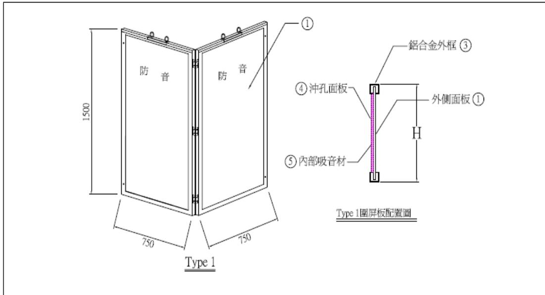
圖 10 移動式隔音屏設計圖
