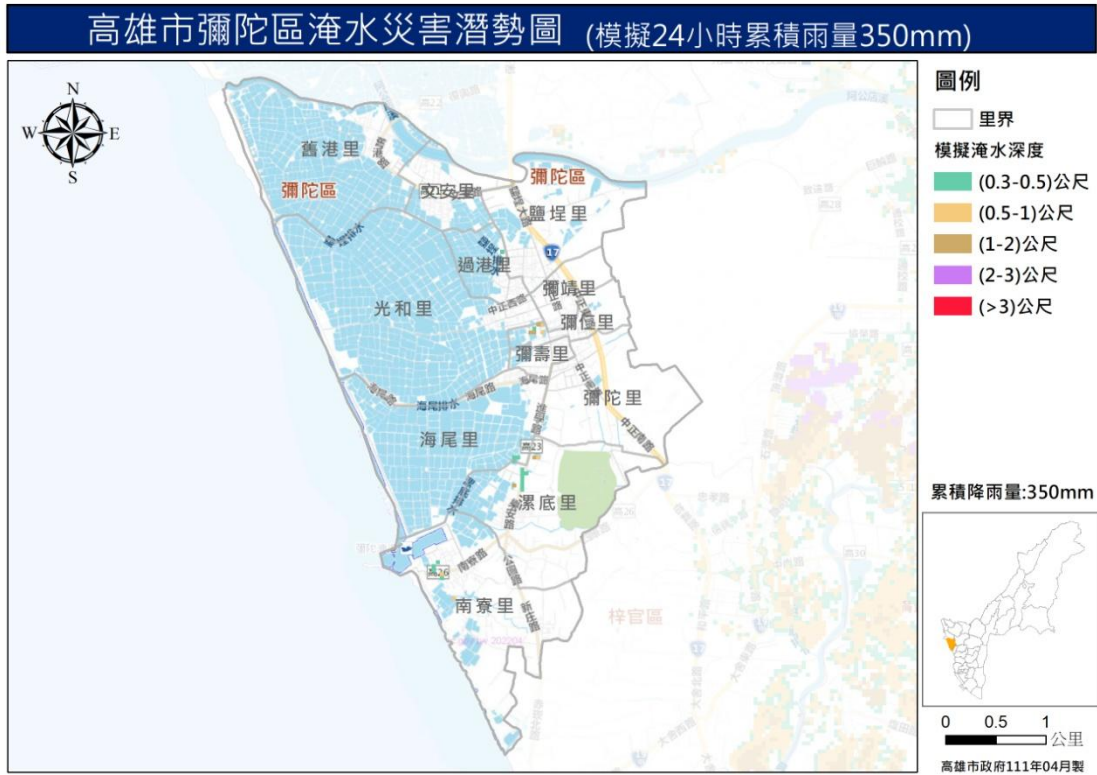
圖 7 彌陀區淹水災害潛勢圖 (模擬 24 小時累積降雨量 350mm)
