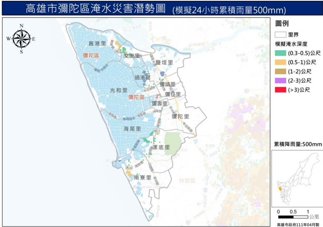
圖 6 彌陀區淹水災害潛勢圖 (模擬 24 小時累積降雨量 500mm)
