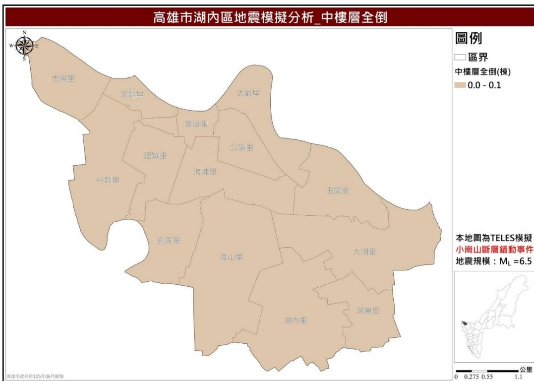
圖 41 湖內區小崙山斷層錯動事件中樓層全倒推估圖
