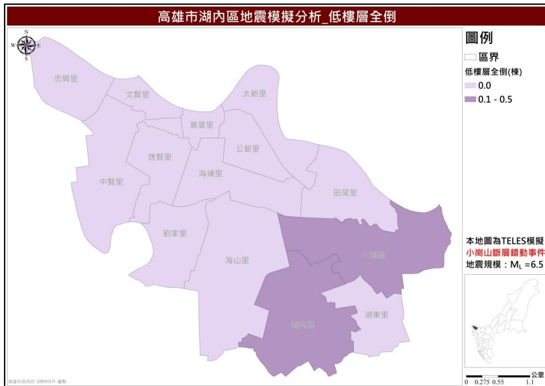
圖 39 湖內區小崙山斷層錯動事件低樓層全倒推估圖
