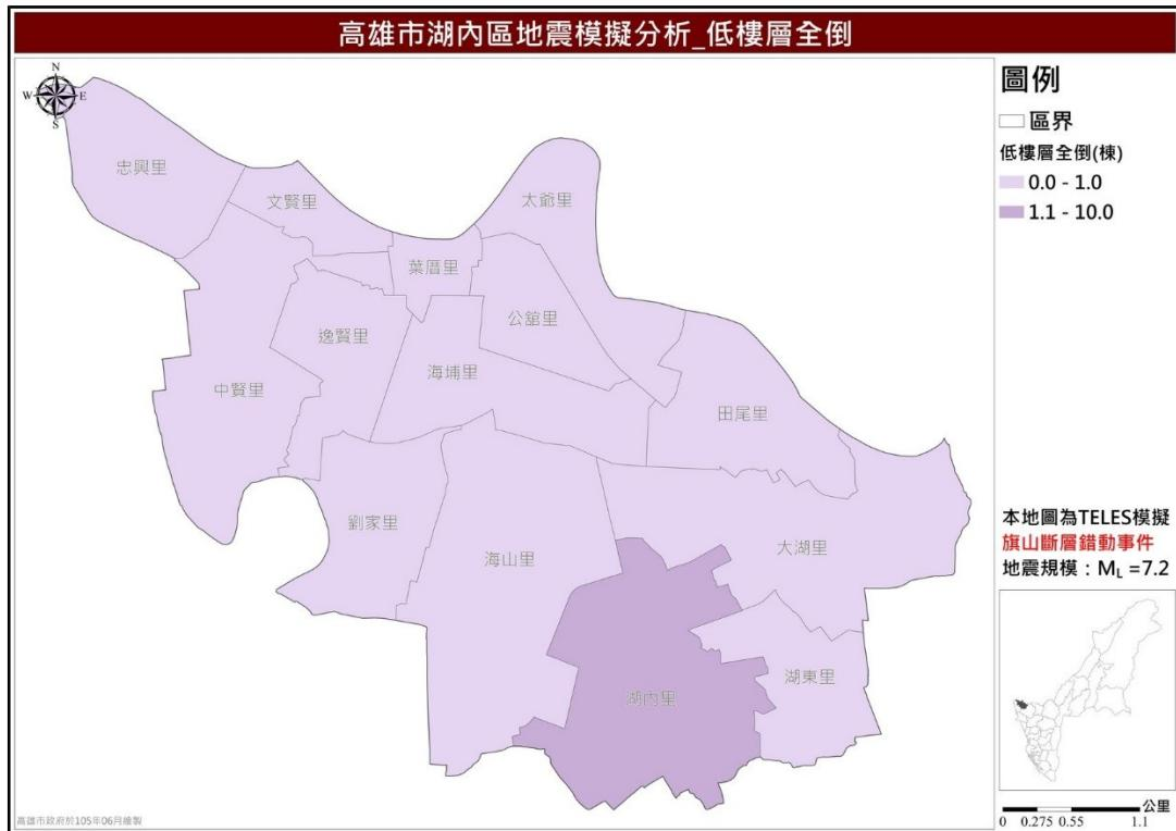
圖 21 湖內區旗山斷層錯動事件低樓層全倒推估圖
