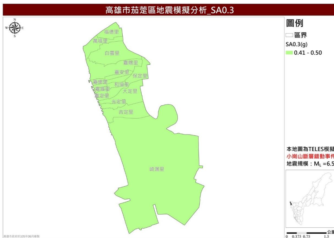
圖 13 小崗山斷層錯動事件短周期譜加速度（SA0.3）分布圖
