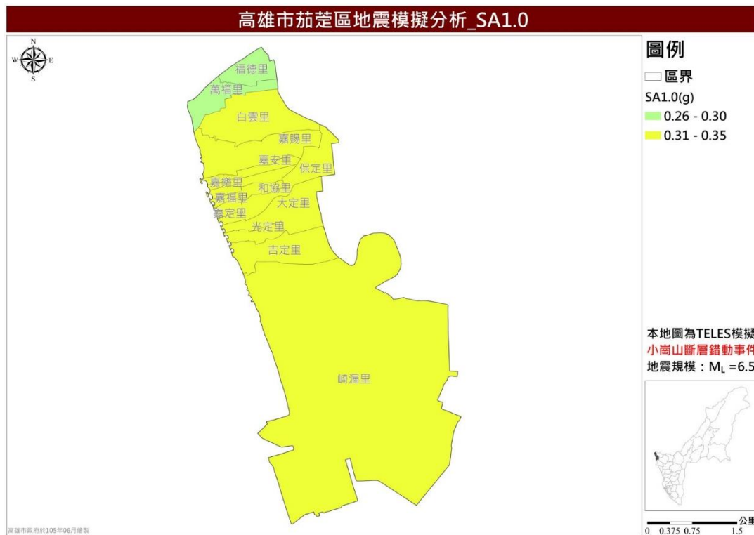
圖 14 小崗山斷層錯動事件長周期譜加速度（SA1.0）分布圖
