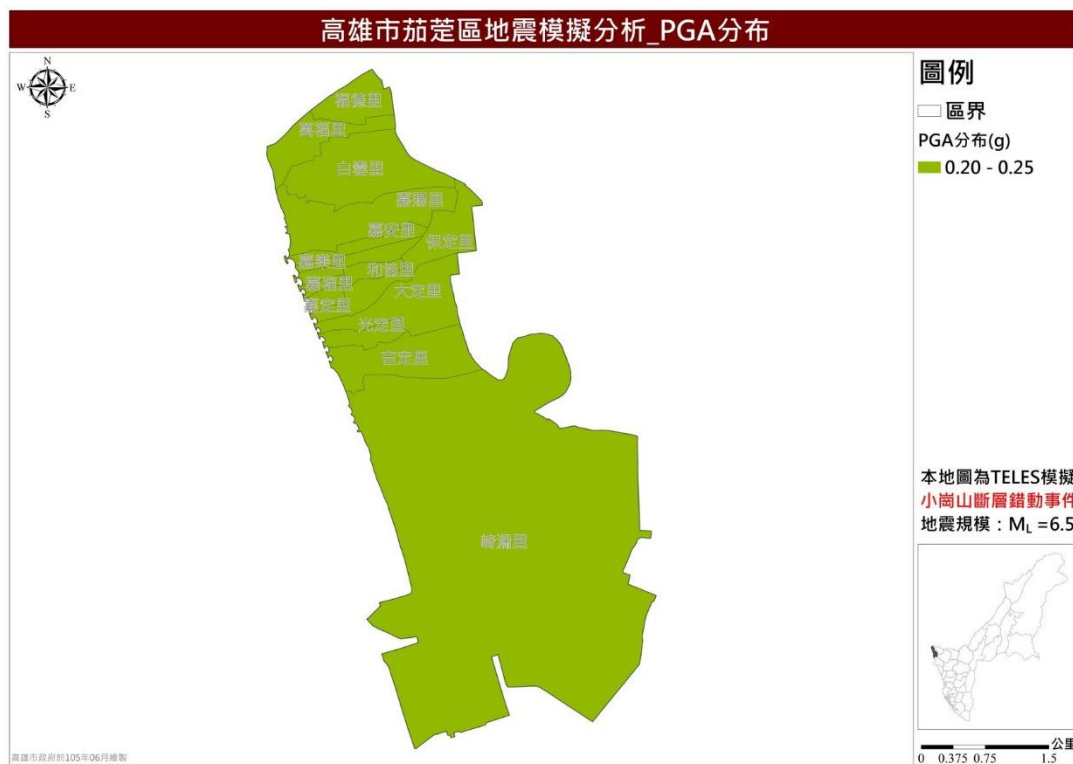
圖 12 小崗山斷層錯動事件最大地表加速度（PGA）分布圖
