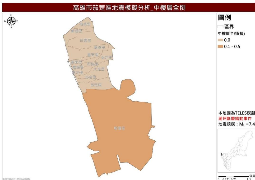
圖 59 茄萣區潮州斷層錯動事件中樓層全倒推估圖
