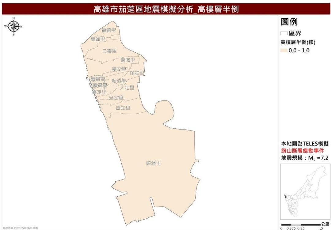
圖 24 茄萣區旗山斷層錯動事件高樓層半倒推估圖
