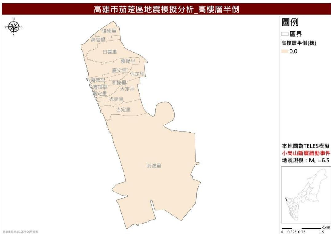
圖 42 茄萣區小崙山斷層錯動事件高樓層半倒推估圖
