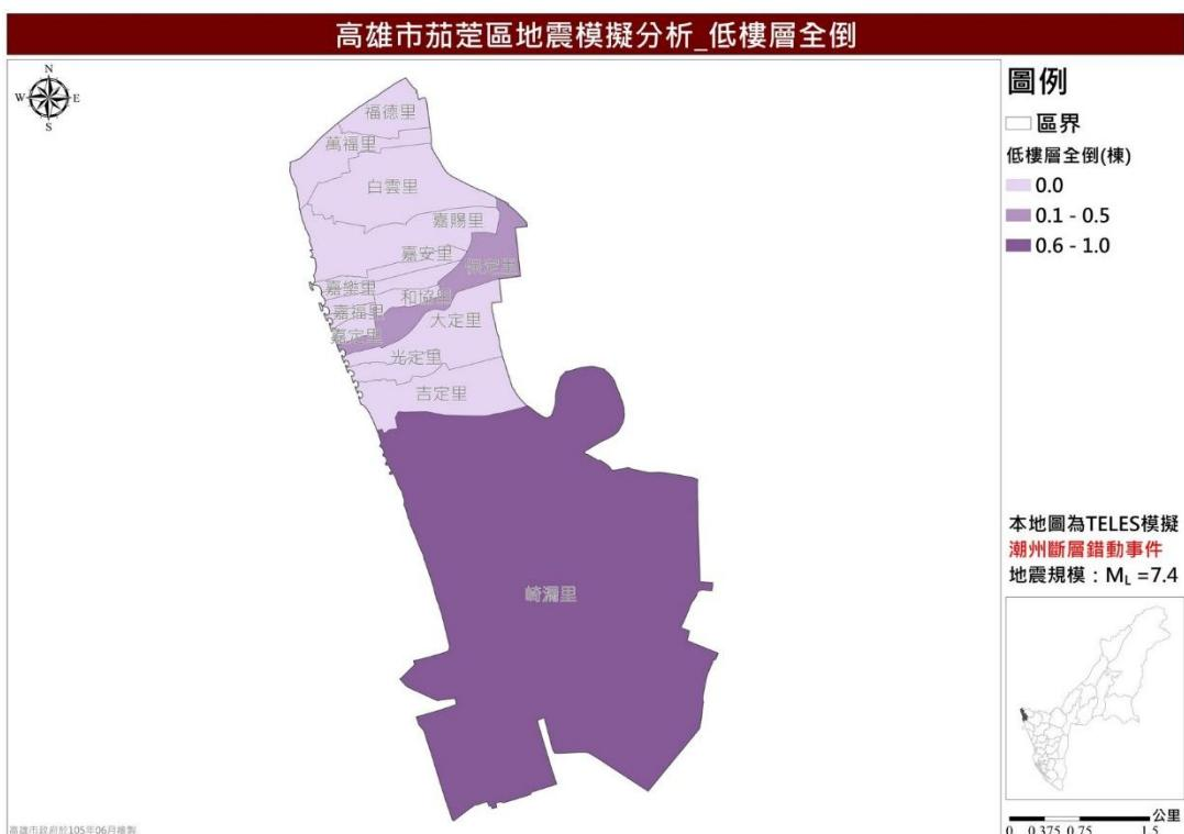
圖 57 茄萣區潮州斷層錯動事件低樓層全倒推估圖
