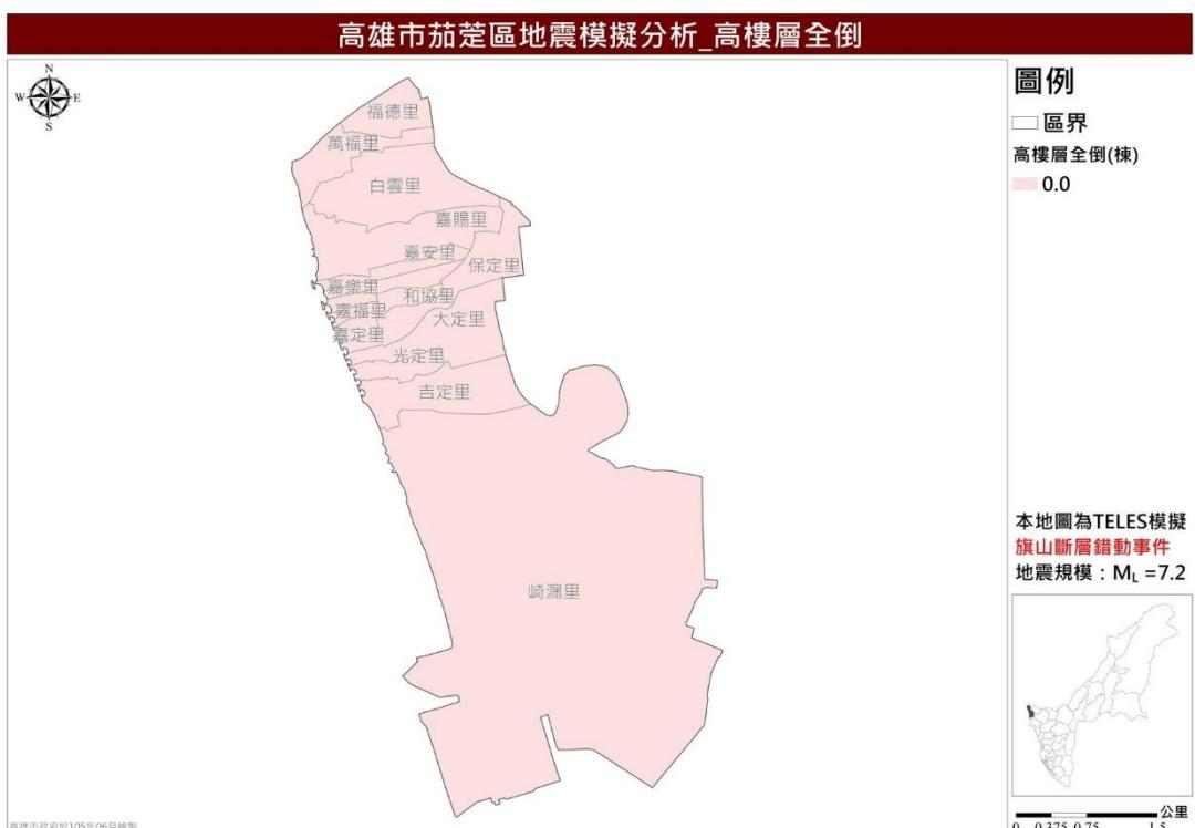
圖 25 茄萣區旗山斷層錯動事件高樓層全倒推估圖
