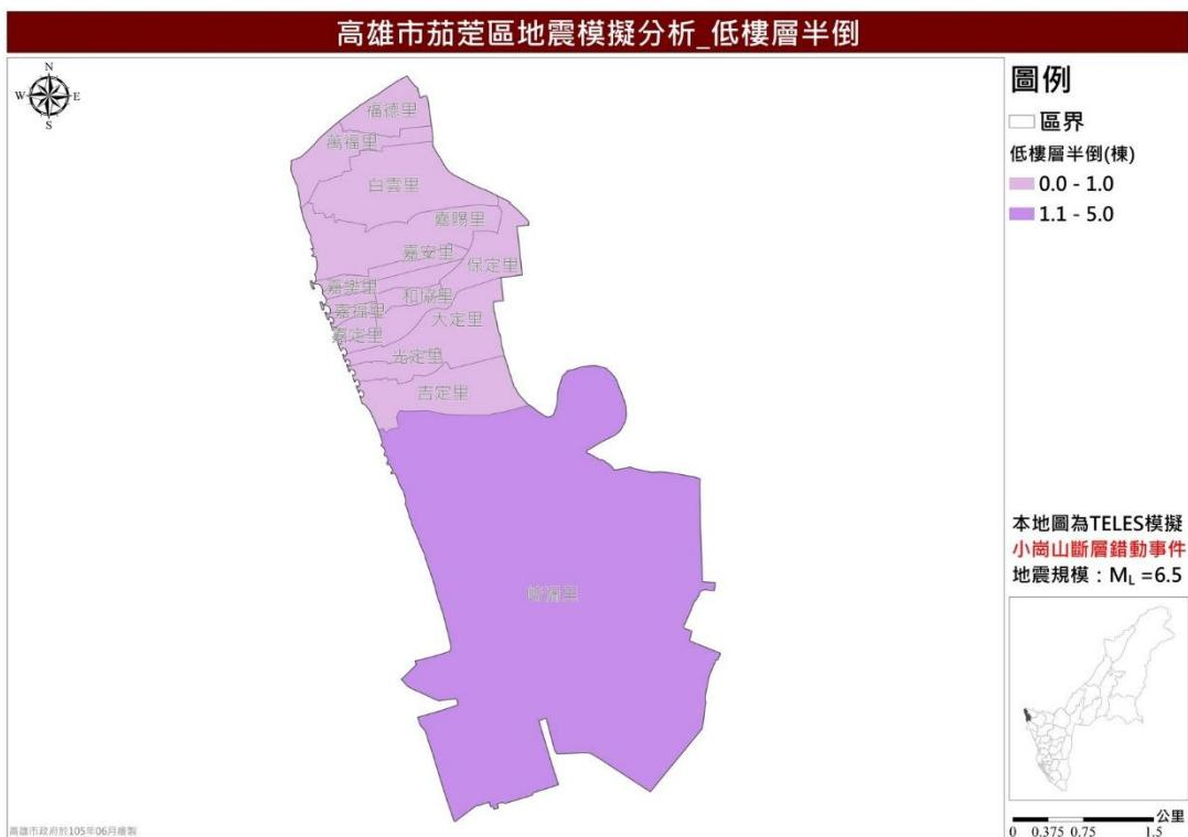
圖 38 茄萣區小崗山斷層錯動事件低樓層半倒推估圖
