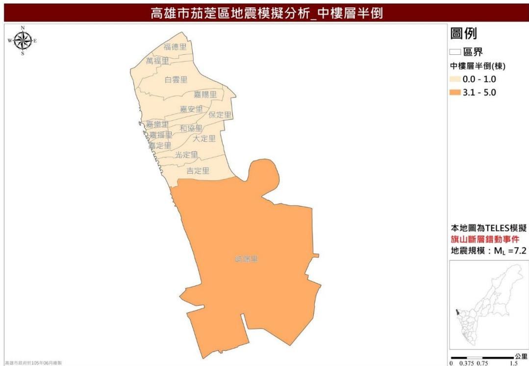
圖 22 茄萣區旗山斷層錯動事件中樓層半倒推估圖
