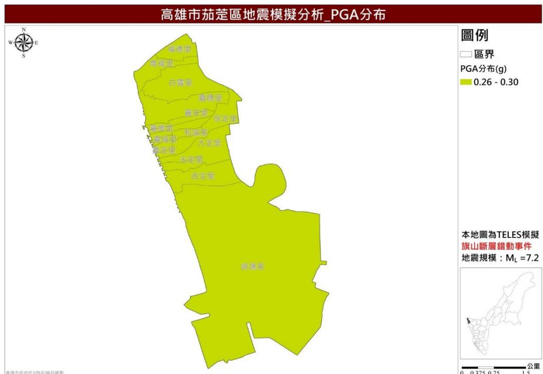
圖 16 茄萣區旗山斷層錯動事件最大地表加速度(PGA)分佈圖
