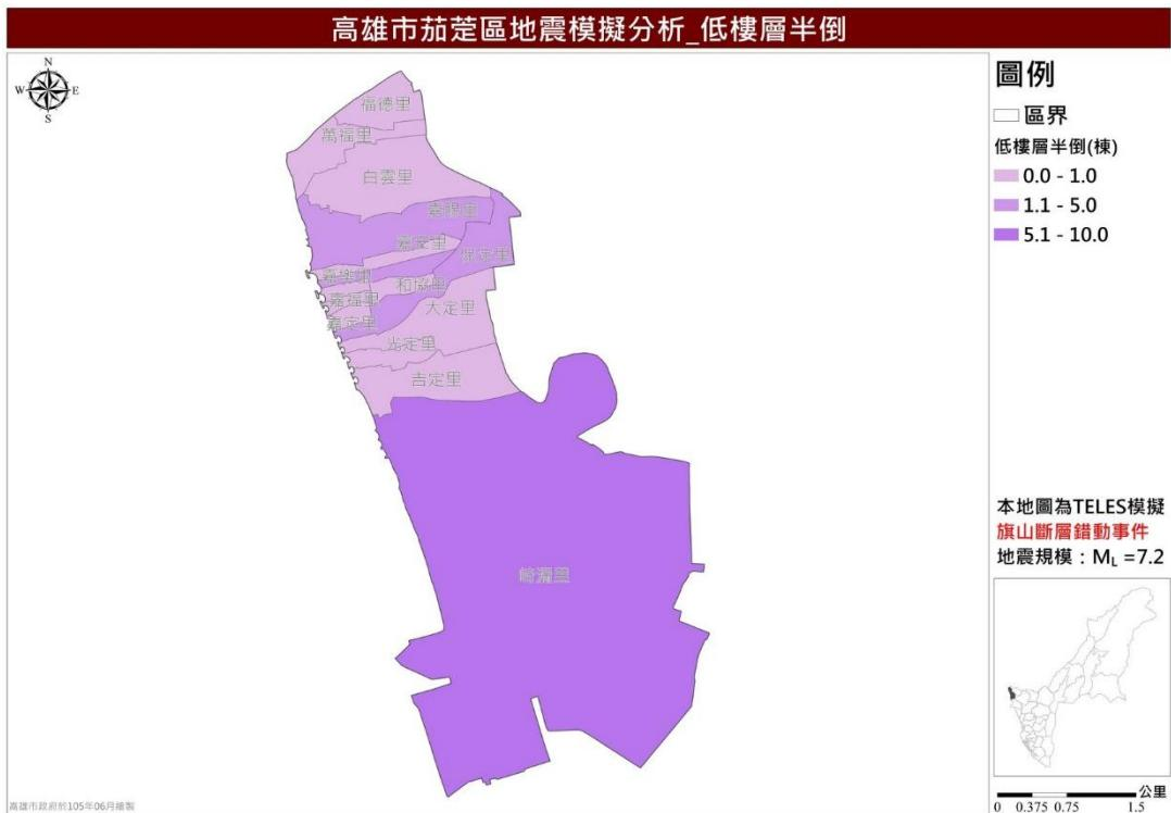
圖 20 茄萣區旗山斷層錯動事件低樓層半倒推估圖
