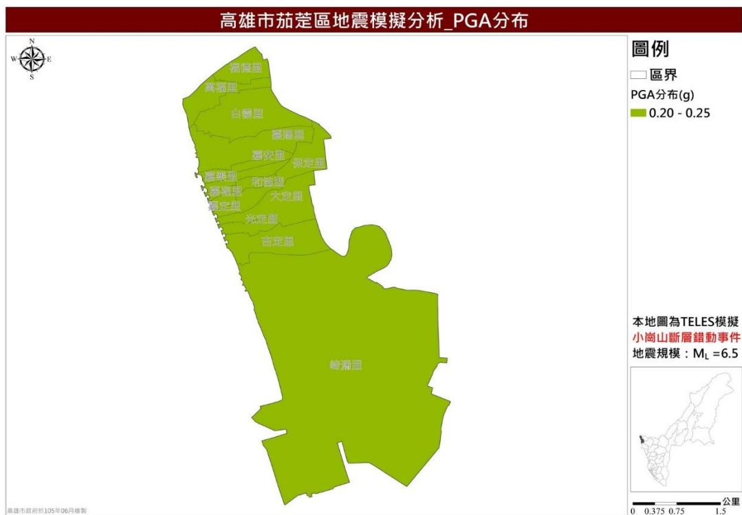
圖 34 茄萣區小崗山斷層錯動事件最大地表加速度(PGA)分佈圖
