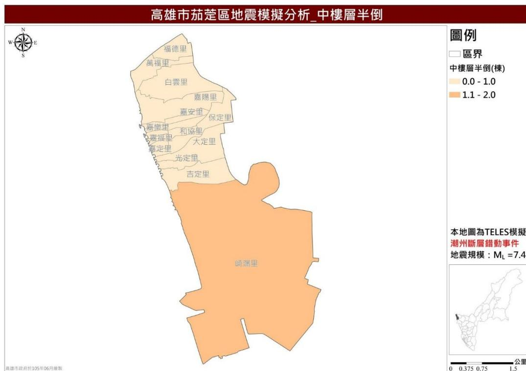
圖 58 茄萣區潮州斷層錯動事件中樓層半倒推估圖
