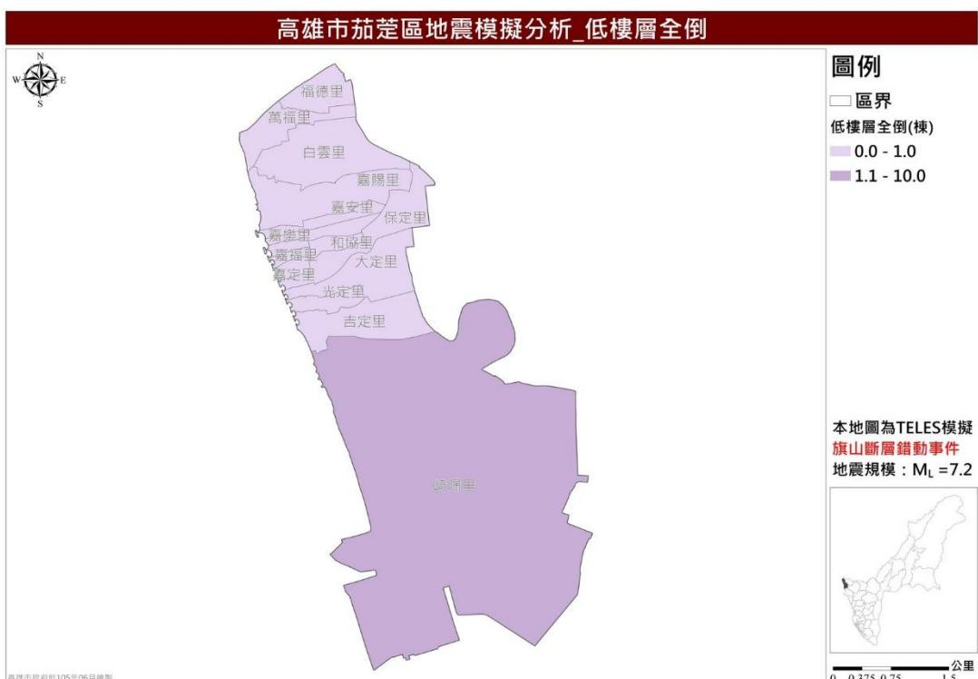
圖 21 茄萣區旗山斷層錯動事件低樓層全倒推估圖
