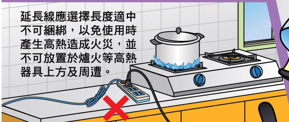
用延長線應有過載自動斷電功能，避免同時使用，並分別插在不同插座。
