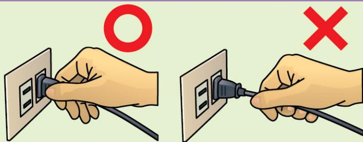
拔下延長線或電器電線時，應手持插頭取下，不可僅拉電線，以免造成電線內部銅線斷裂。
