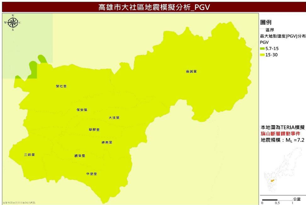
圖 13 旗山斷層錯動事件最大地表速度值 (PGV) 分布圖
