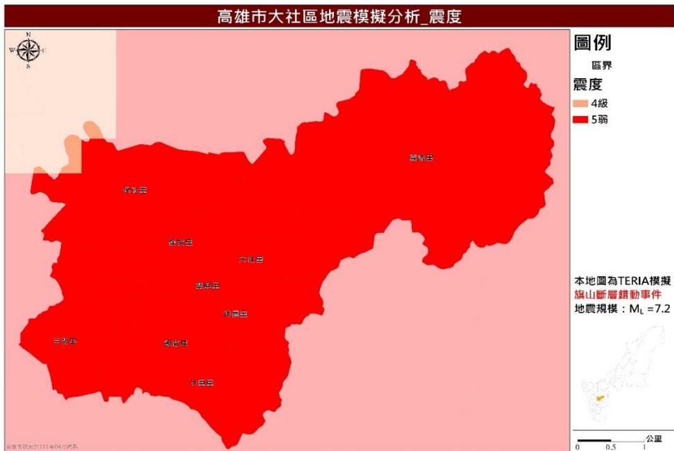
圖 14 旗山斷層錯動事件震度分布圖
