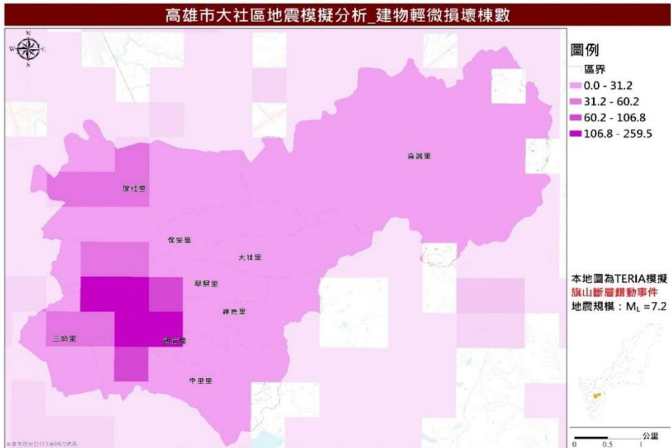
圖 18 旗山斷層錯動事件建物輕微損壞數推估圖
