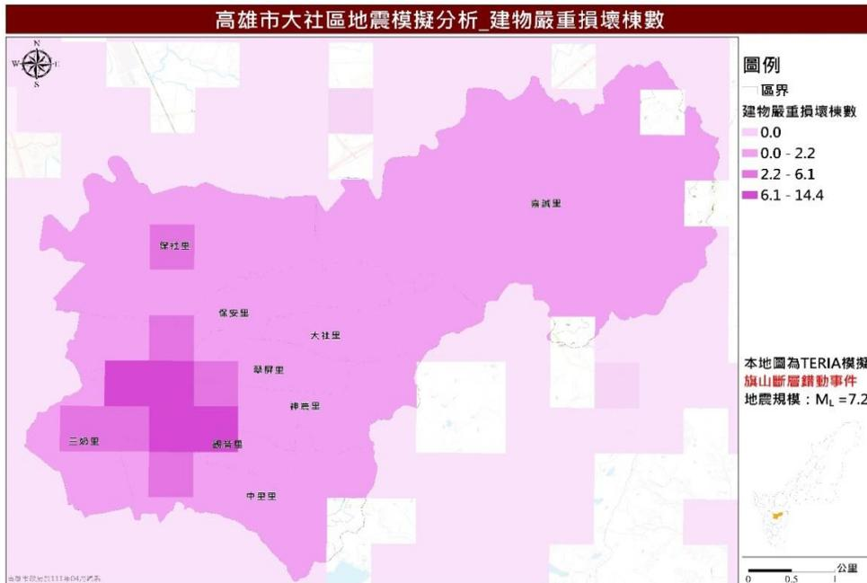
圖 16 旗山斷層錯動事件建物嚴重損壞棟數推估圖
