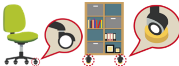
圖 79 具有煞車裝置的四輪椅
