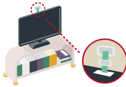
圖 87 裝卸式移動防止帶、腳輪托盤 資料來源：本手冊繪製
