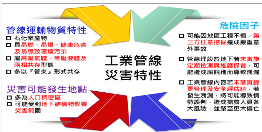
圖 30 工業管線災害特性
