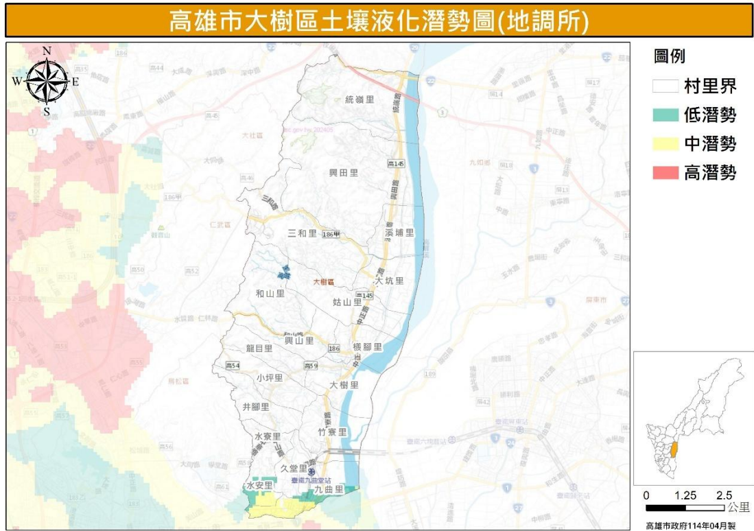
圖 23 大樹區土壤液化潛勢圖 (資料來源：地質調查及礦業管理中心)
