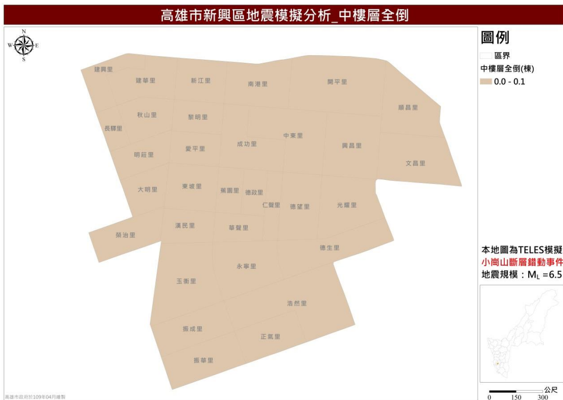
圖 17 小崗山斷層錯動事件中樓層全倒棟數推估圖
