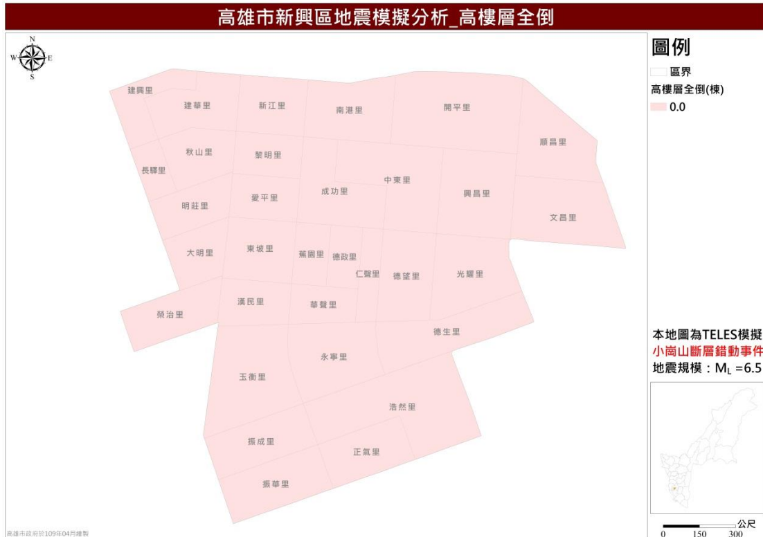
圖 18 小崗山斷層錯動事件高樓層全倒棟數推估圖
