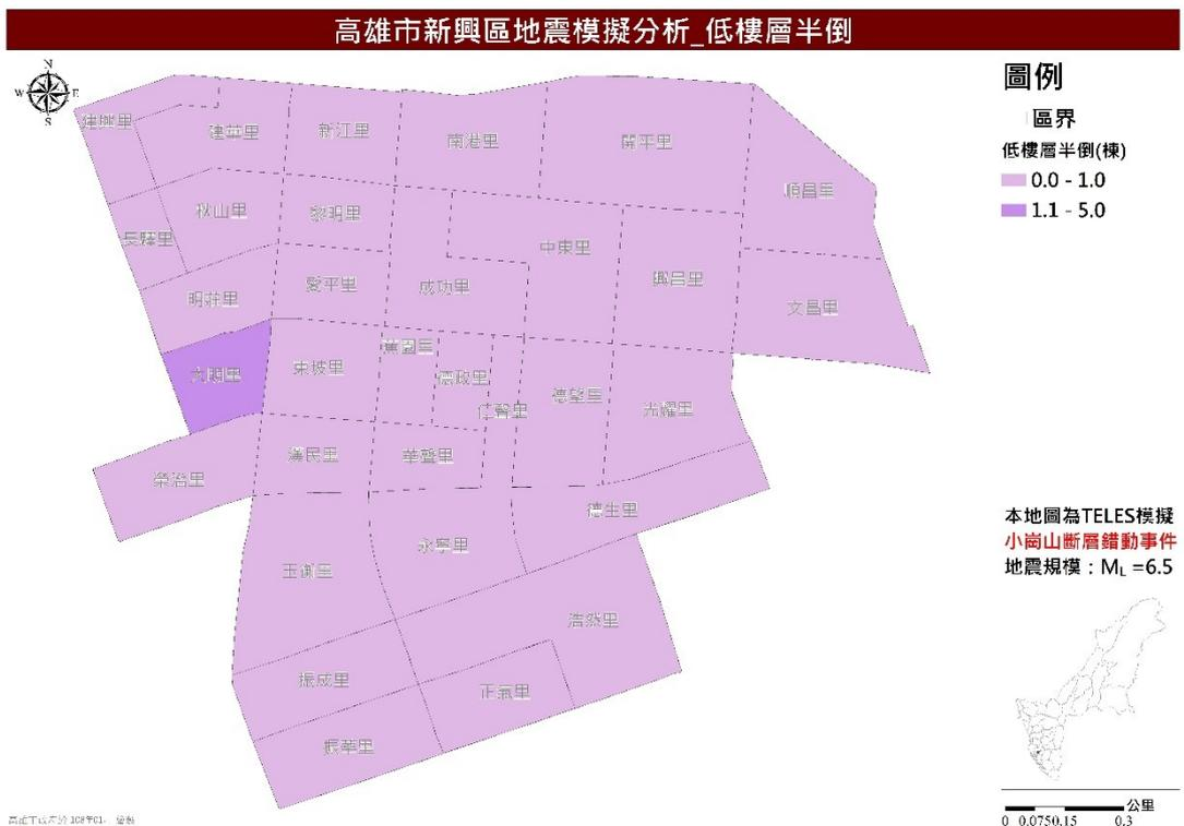
圖 37 新興區小崗山斷層錯動事件低樓層半倒推估圖
