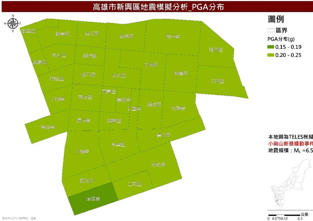
圖 33 新興區小崗山斷層錯動事件最大地表加速度(PGA)分佈圖
