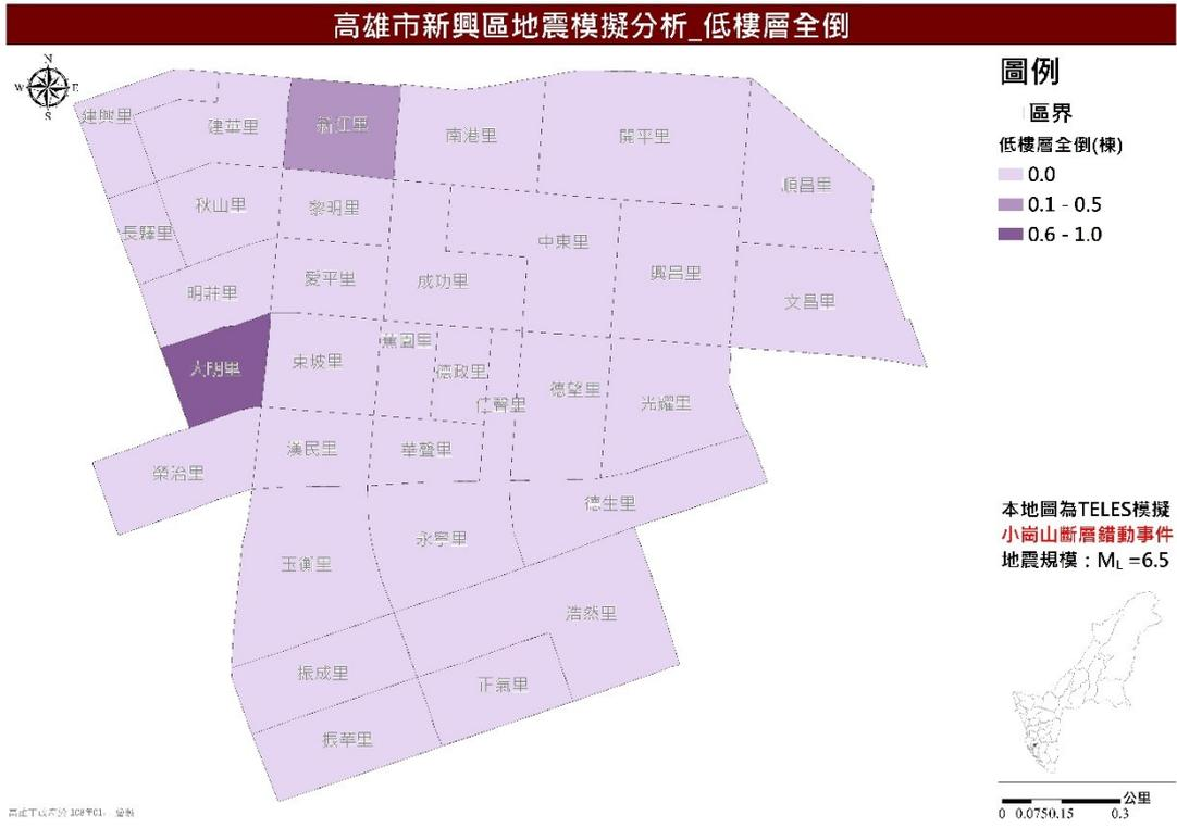
圖 38 新興區小崗山斷層錯動事件低樓層全倒推估圖
