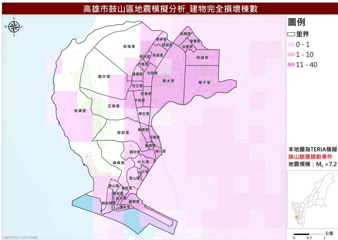
圖 15 旗山斷層錯動事件建物完全損壞棟數推估圖
