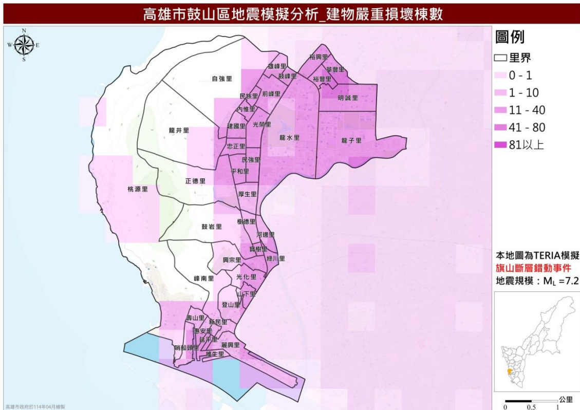
圖 16 旗山斷層錯動事件建物嚴重損壞棟數推估圖
