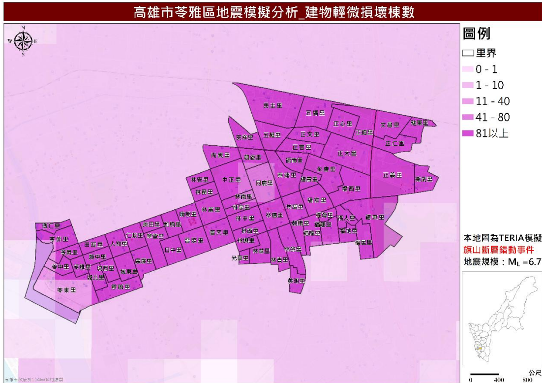
圖 16 旗山斷層錯動事件建物輕微損壞棟數推估圖
