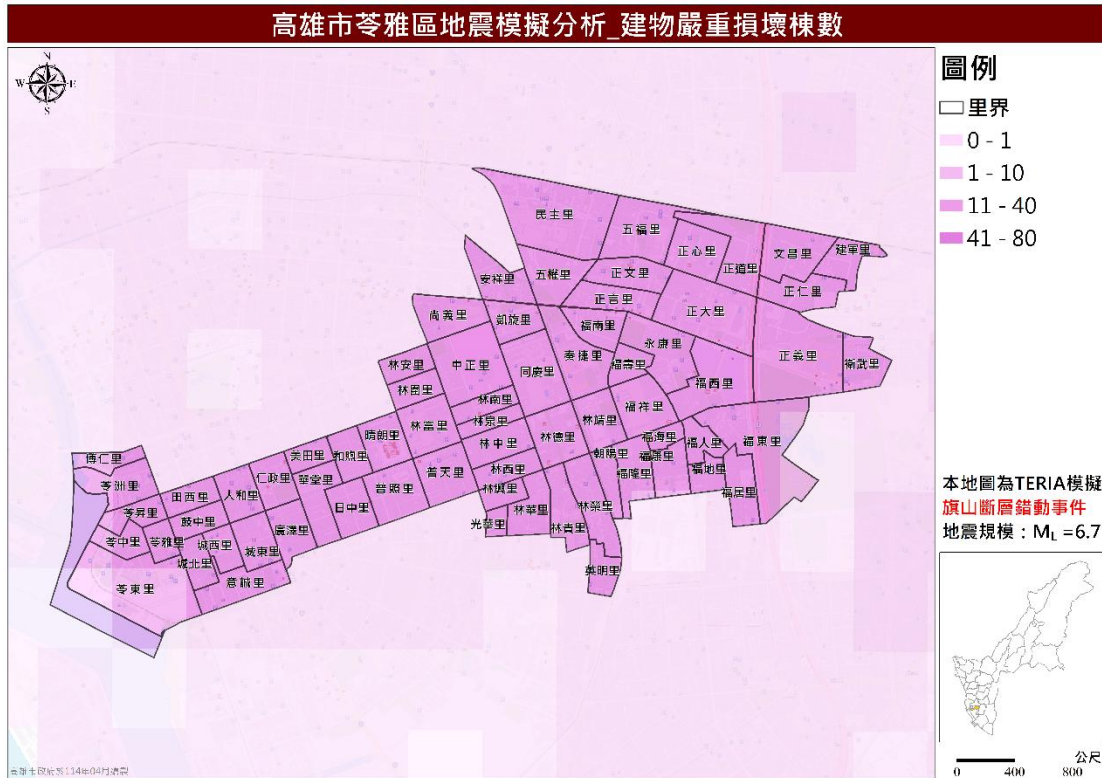
圖 14 旗山斷層錯動事件建物嚴重損壞棟數推估圖
