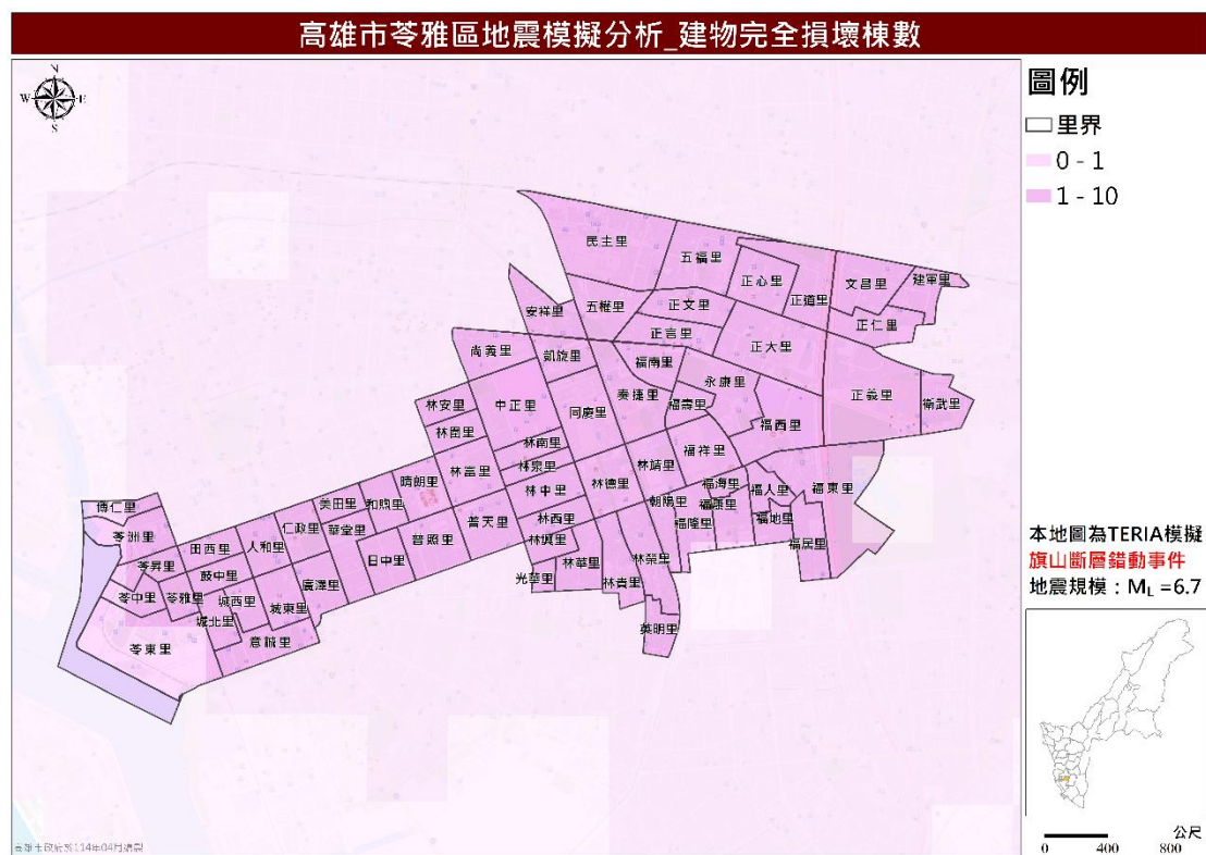
圖 13 旗山斷層錯動事件建物完全損壞棟數推估圖
