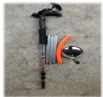
圖、病媒監測人員自製屋簷溝積水檢查反光鏡
