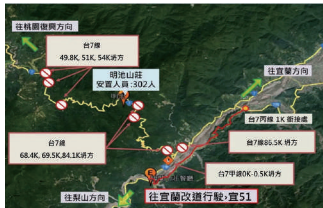
圖 1-22、大同鄉台 7 線重大崩塌災害環境示意圖 資料來源：交通部
