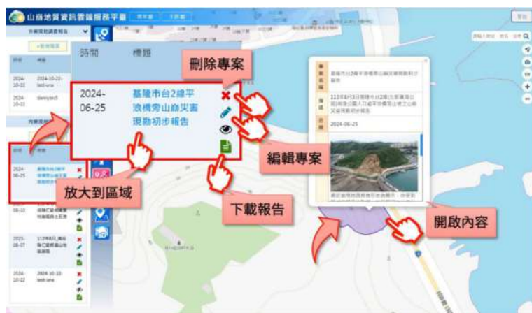
圖 3-34、山崩地質資訊雲端服務平臺之山崩地質調查即時資訊展示模組雛形功能，以基隆臺 2 線平浪橋旁山崩災害現勘為例
