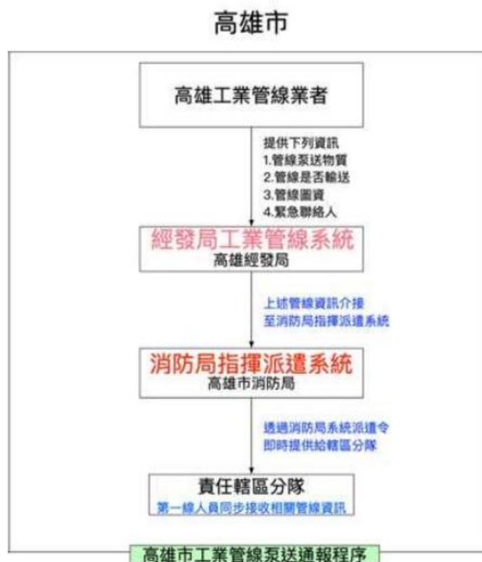
圖 50 本市工業管線平時泵送通報程序 (資料來源：經濟部「工業管線災害防救業務計畫」)
