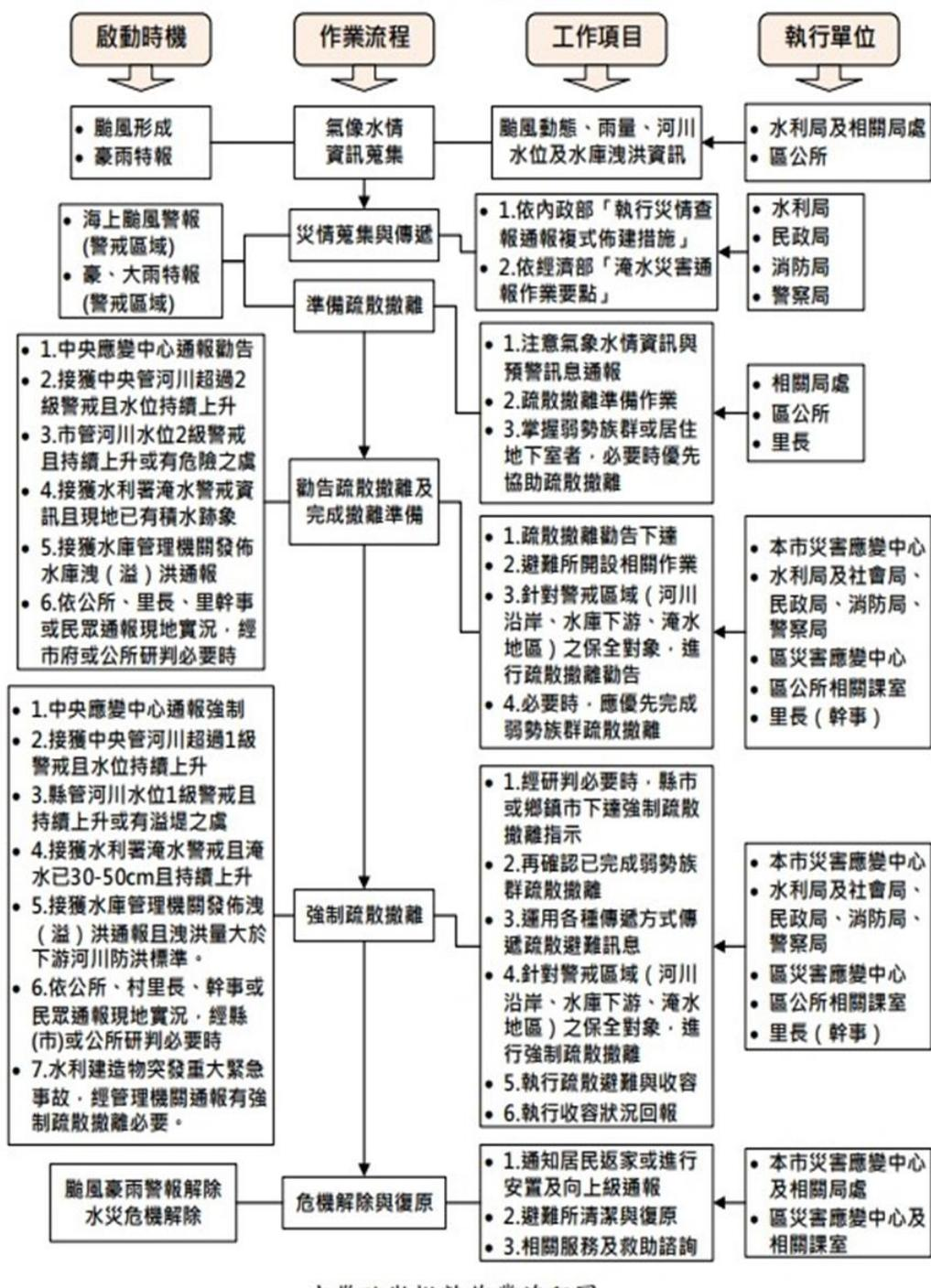
圖 41 高雄市水災疏散撤離作業流程圖
