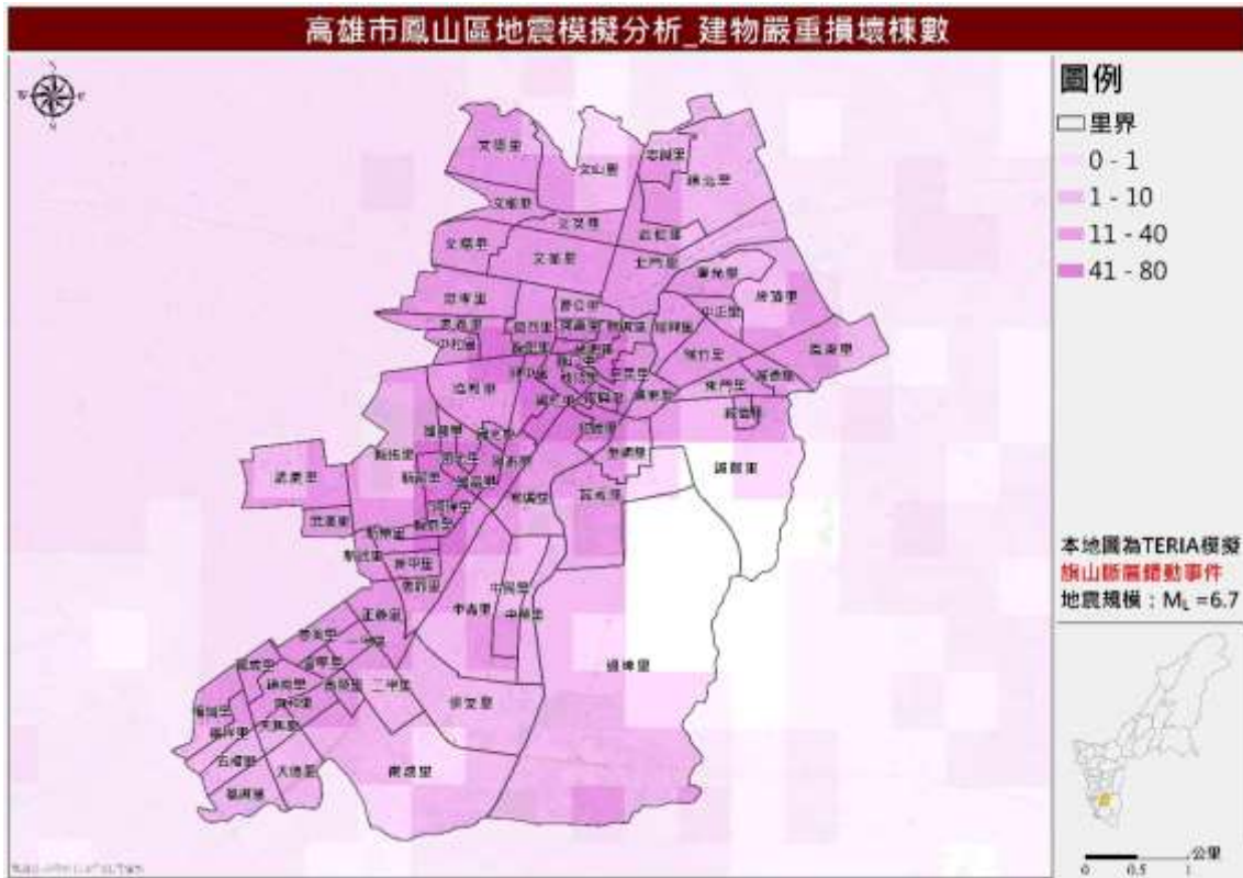
圖 17 旗山斷層錯動事件建物嚴重損壞棟數推估圖
