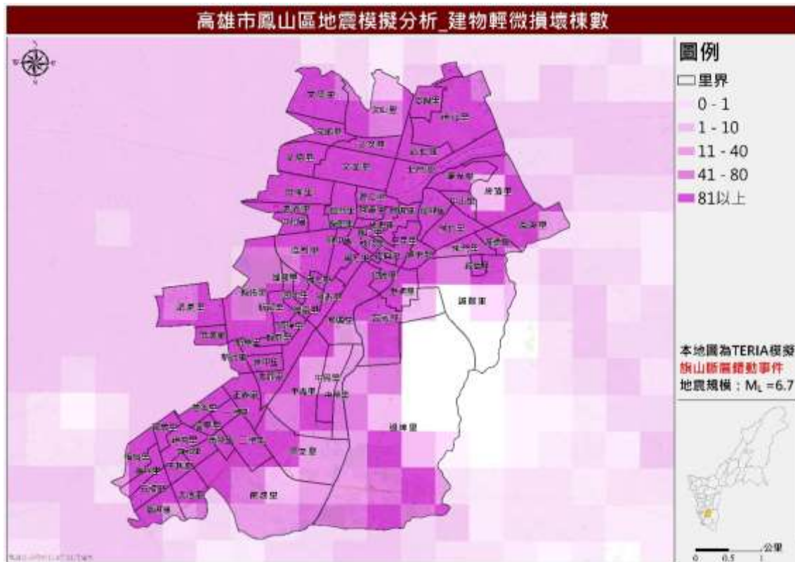
圖 19 旗山斷層錯動事件建物輕微損壞數推估圖
