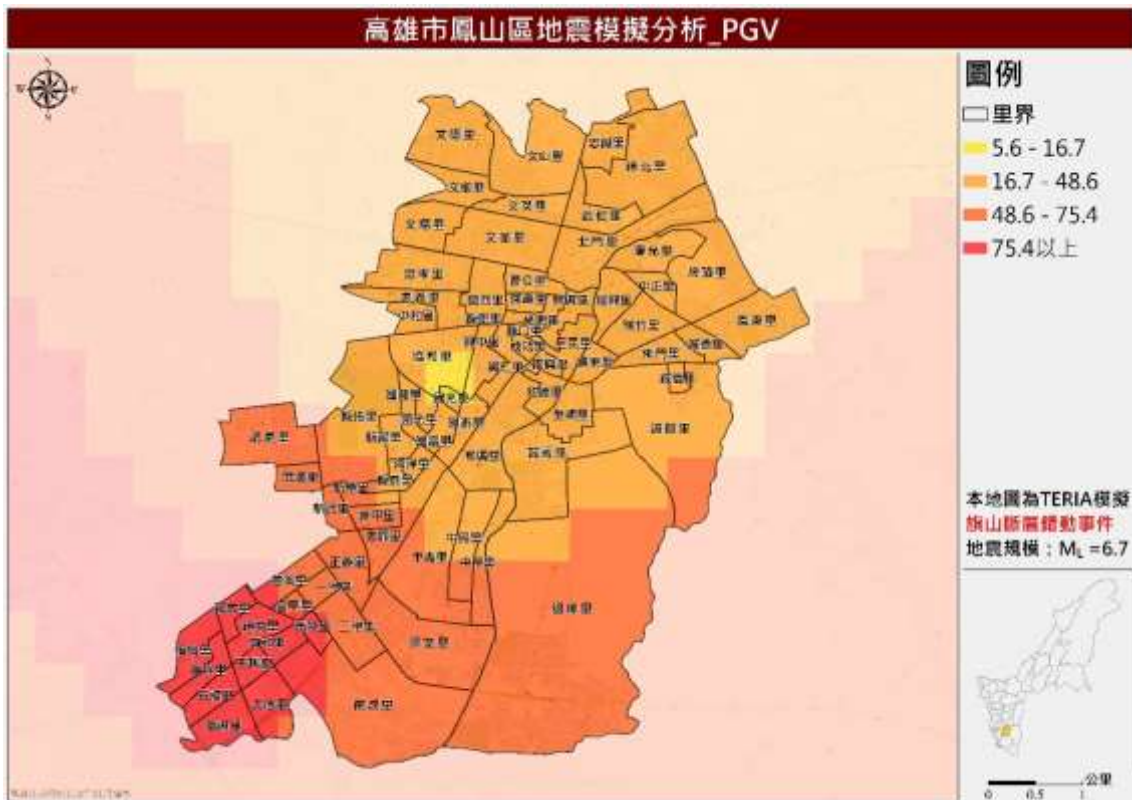
圖 14 旗山斷層錯動事件最大地表速度值（PGV）分布圖
