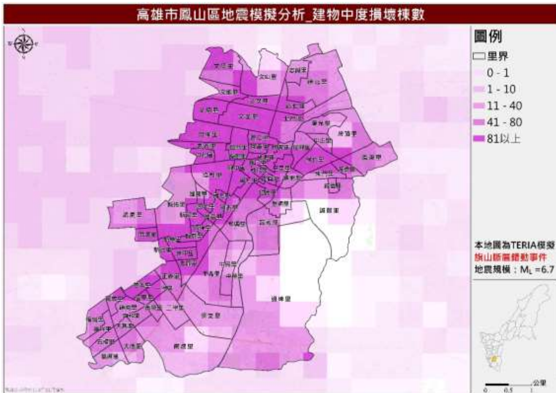
圖 18 旗山斷層錯動事件建物中度損壞棟數推估圖
