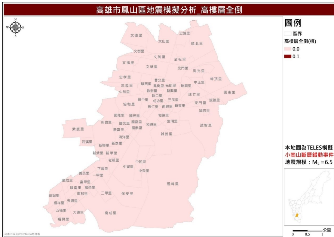
圖 20 小崗山斷層錯動事件高樓層全倒棟數推估圖
